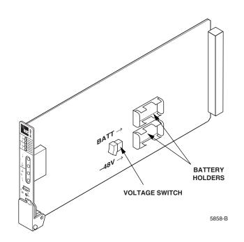
Figure 571-1. Streaker Module
